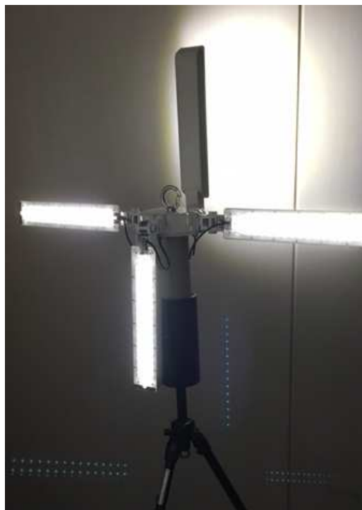
自在式アームにより光の方向を、自由に形を変えられる
